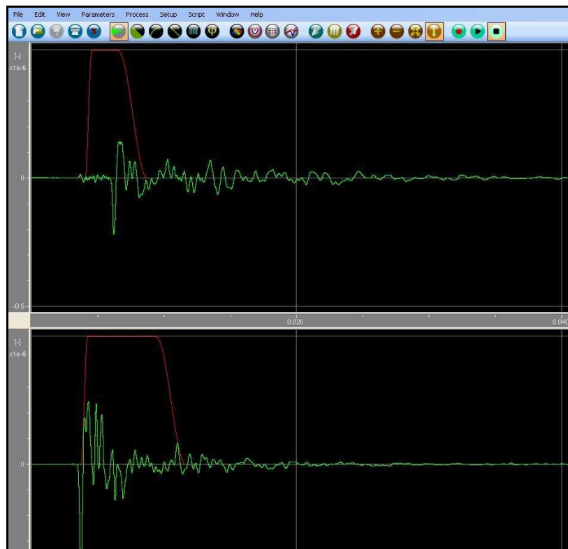
A Dirac program kezelőfelülete a mérés impulzus-válasz függvényével és az időablakkal
